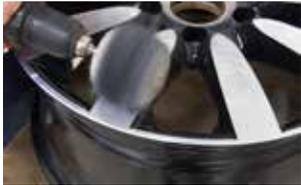
Die Polierkugel ist in den Durchmessern Ø 75 mm und Ø 100 mm inkl. Aufspanndorn zur Verwendung in Stabschleifern, Bohrmaschinen und Akku-Bohrmaschinen erhältlich.
