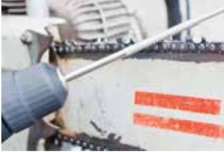
Für alle gängigen Sägeketten. Durch Diamantbestückung auch für Hartmetallkettenzähne geeignet. Kann durch Abziehen des Feilenheftes auch im Akkuschauber verwendet werden.
