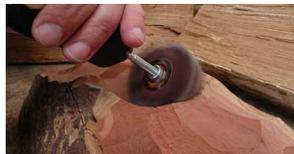
Zur Verwendung auf Bohrmaschinen und flexiblen Wellen, sowie – unter Beachtung der Höchstdrehzahl – auf dem Kaindl Multi-Shaft (Seite 6) geeignet.
