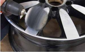
Die Polierkugel ist in den Durchmessern Ø 75 mm und Ø 100 mm inkl. Aufnahmedorn zur Verwendung in Stabschleifern, Bohrmaschinen und Akku-Bohrmaschinen erhältlich.
