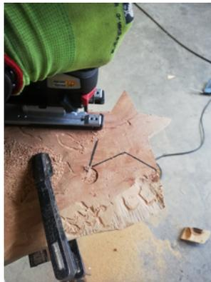
Sobald der Stern ausgesägt ist, kann mit ihm weitergearbeitet werden. Spannt ihn dazu nun sicher ein, sodass ein Verrutschen nicht möglich ist. Nun kann in einen Winkelschleifer der Multi-Carver eingespannt werden. Eventuell benötigt ihr dazu noch den Multi-Shaft (Art. Nr. 19021) Zeichnet den Umriss der Kerze oder des Teelichts in der Mitte mit einem Stift auf und fräst diesen Teil anschließend aus.
