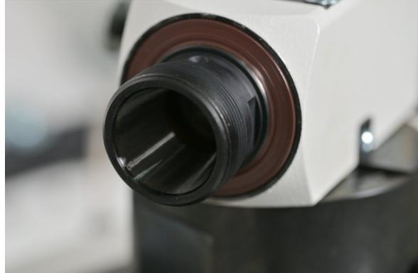
Schrauben Sie die Spannzange + Spannzangenmutter von der Aufnahme herunter. Anschließend können Sie die Spannzange entsprechend wechseln.
