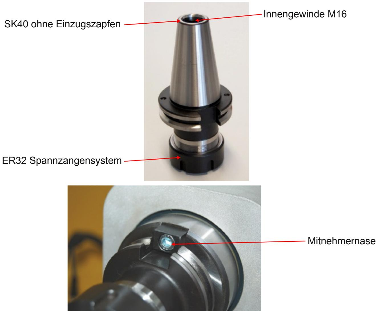
Die SK40 Aufnahme wird mit aufgespanntem Fräser von vorne in den Innenkegel der A-Achse eingeführt. Bitte achten Sie darauf, dass der Innenkegel wie die SK40 Aufnahme sauber und schmutzfrei sind. Von der hinteren Seite der A-Achse wird mit dem mitgelieferten Inbusschlüssel SW8 die SK40 Aufnahme festgezogen. Es ist auf die richtige Nasennut zu achten.
