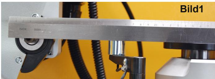
Ausrichten der Magnetklemmung und der Schleifspindel
