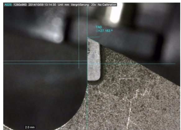
Sollte bei wiederholtem Messen die Winkelposition nicht korrekt sein, so richten Sie den Sägezahn mit dem Fadenkreuz der Kamera und der Zahnbrust aus.
