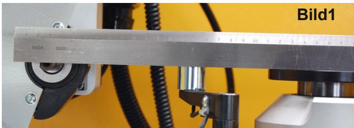
**Bild1** Ausrichten der Magnetklemmung und der Schleifspindel
