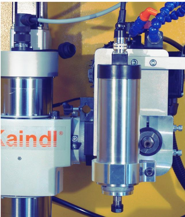
Die HF-Spindel kann auch vertikal betrieben werden.
